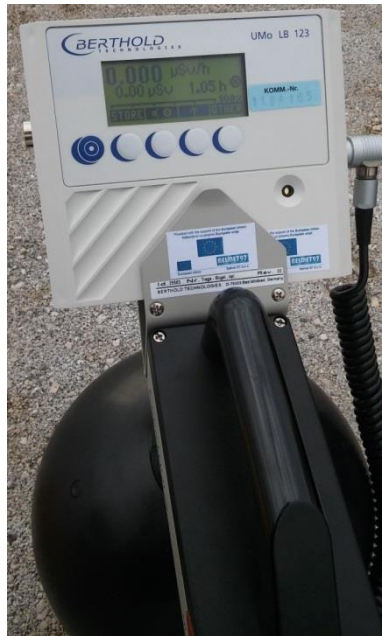
Slika 5. Detekcija neutrona uređajem Berthold UMo LB 123
