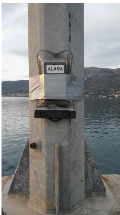
Slika 1. Postavljeni elektronički dozimetar ALARA za određivanje brzine prostornog (ambijentalnog) ekvivalenta doze, H^*(10)/t , nasuprot podmornice
